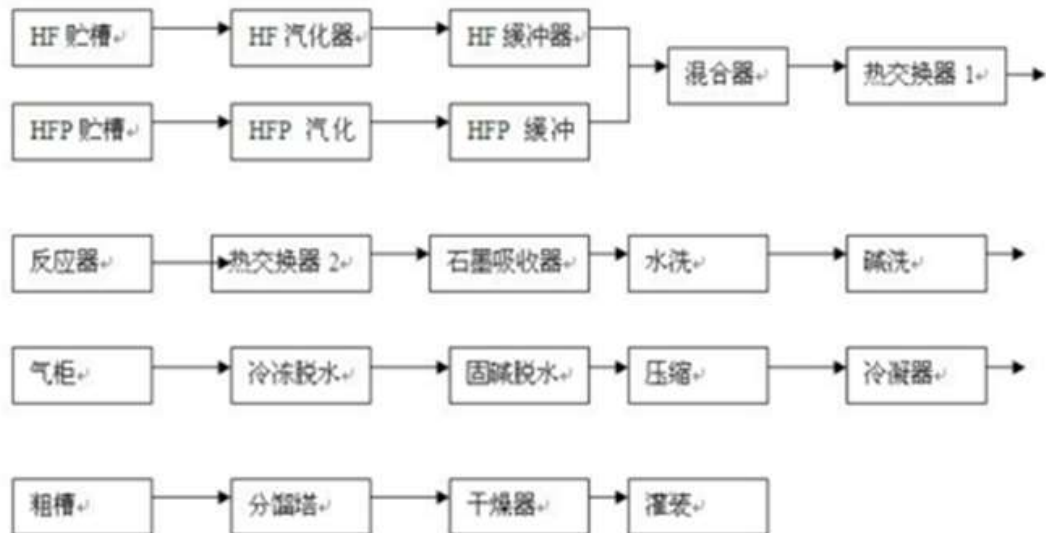
图表 3：HFC-32 工艺流程简图
