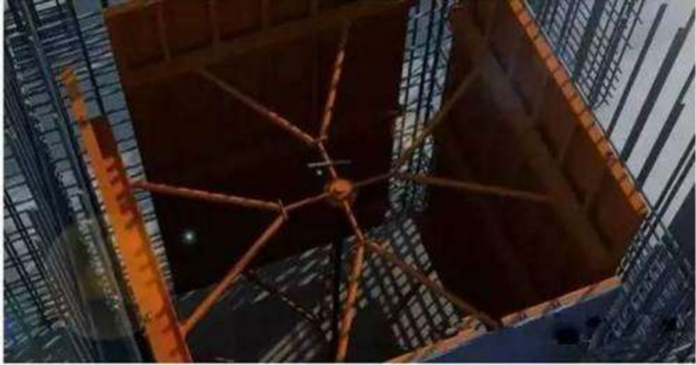
7、剪力墙、柱模板安装。
