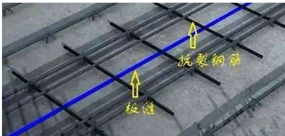
13、楼板内预埋管线安装、面层钢筋绑扎。
